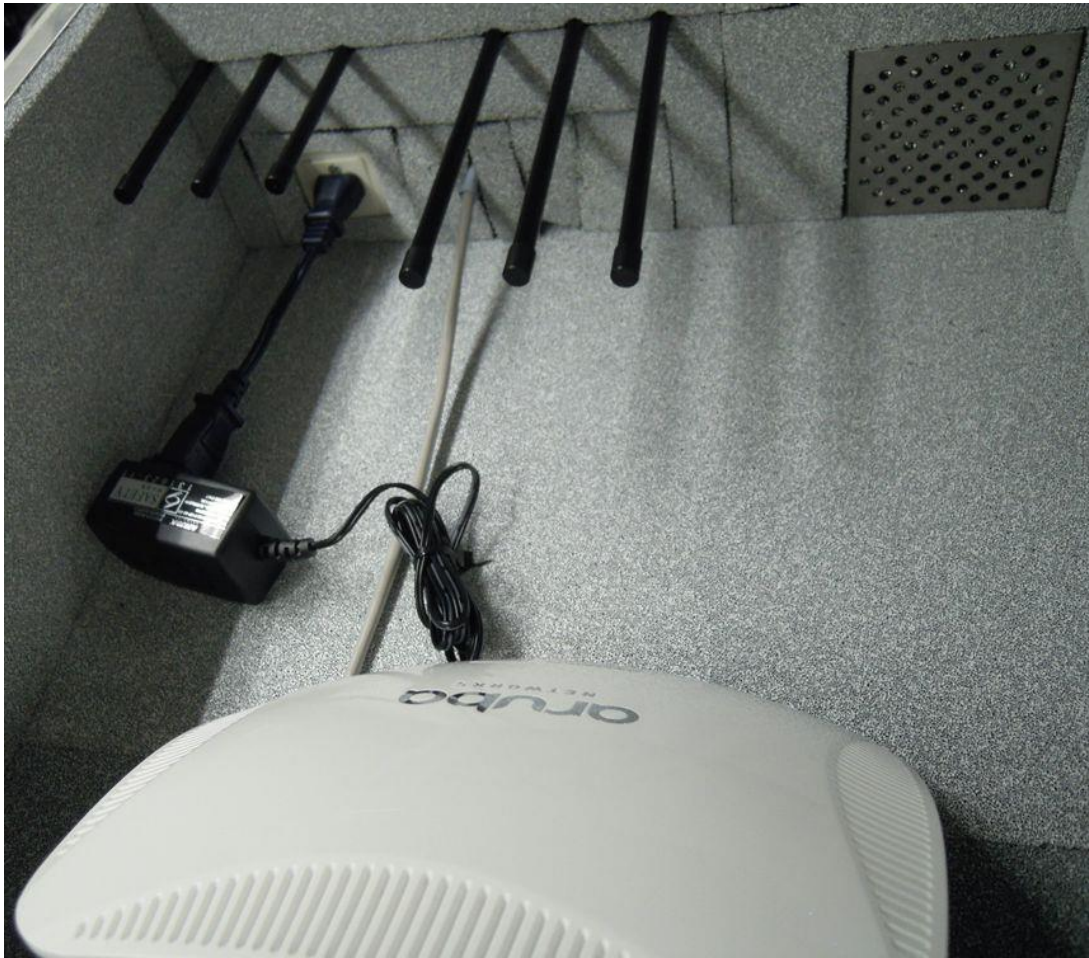
図 3 テスト用配線 (暗箱内側)
